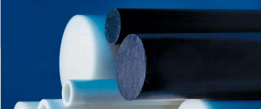
**PET** ist ein sehr gut zerspanbarer technischer Kunststoff, der die höchste Festigkeit sowie die niedrigste Feuchtigkeitsaufnahme unter den drei vorgestellten Werkstoffen (unverstärkte Typen) aufweist. PET isoliert elektrisch optimal und dehnt sich unter Wärmeinfluss nur geringfügig aus. Darüber hinaus verbindet PET gute Gleiteigenschaften mit sehr hoher Verschleißfestigkeit.
